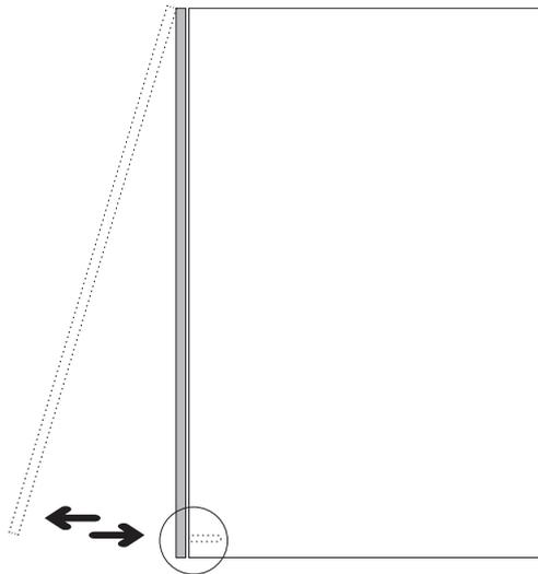
**2** ÜBER DREHEN AM BESCHLAG KANN DIE LUFT ZWISCHEN FRONT UND KORPUS EINGESTELLT WERDEN
