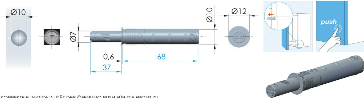
**1** UM EINE KORREKTE FUNKTIONALITÄT DER ÖFFNUNG PUSH FÜR DIE FRONT ZU ERHALTEN, IST ES NOTWENDIG EINEN SPALT VON MINDESTENS 2 MM ZWISCHEN KORPUS UND FRONT ZU HABEN. DIESER SPALT DIENT DAFÜR DAS MIT DEM DRÜCKEN AUF DIE FRONT DER BESCHLAG GEÖFFNET WIRD UND DURCH DIE DÄMPFER DIE FRONT NACH VORNE GESTOSSEN WERDEN KANN
