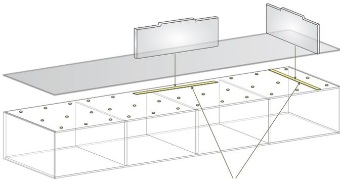
SILIKONSTREIFEN UNTER DEM GLAS ANBRINGEN ZUR AUFLAGE AUF DER ABDECKPLATTE
