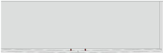
DIE FRONTEN SIND PARALEL ZUM KORPUS, JEDOCH DIE SEITE MIT DEN SCHARNIEREN NÄHER UND DIE VOM PUSH PULL ENTFERNTER VOM KORPUS
