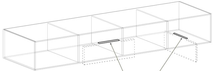
AUSFRÄSUNG OBEN UM IM MÖBELTEIL EINZUSTECKEN ALS HALTERUNG FÜR DAS GLAS
