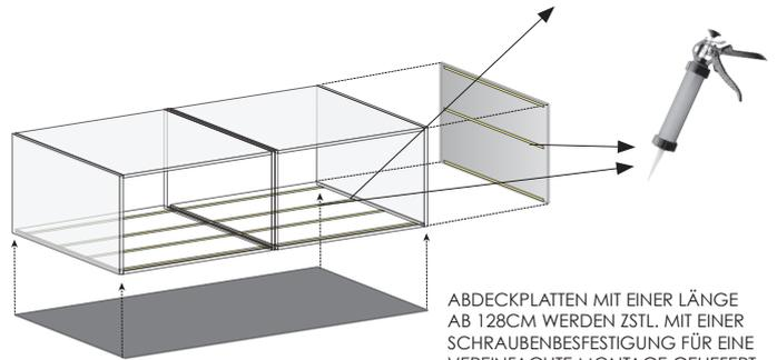
ABDECKPLATTEN MIT EINER LÄNGE AB 128CM WERDEN ZSTL. MIT EINER SCHRAUBENBEFESTIGUNG FÜR EINE VEREINFACHTE MONTAGE GELIEFERT
