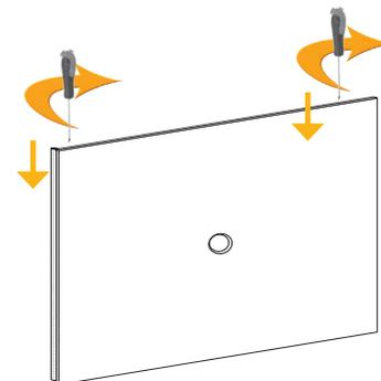
IM ENTGEGEN GESETZTEN UHRZEIGERSINN DREHEN UM POSITIONIERUNG NACH OBEN VORZUNEHMEN
